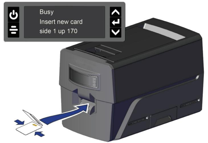
Eingabemagazin mit manueller Befüllung
