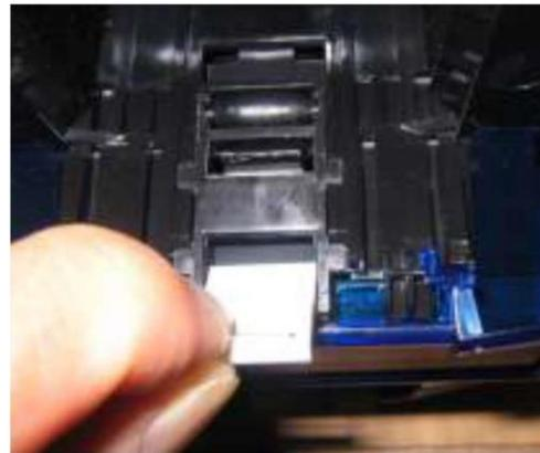
下から（カード排出部から）指を入れてピックアップブロックが落ちないように取り外した穴に指先を当てた状態でトルピックアップブロックを挿入します。ピックアップブロックの向きに注意してください。
