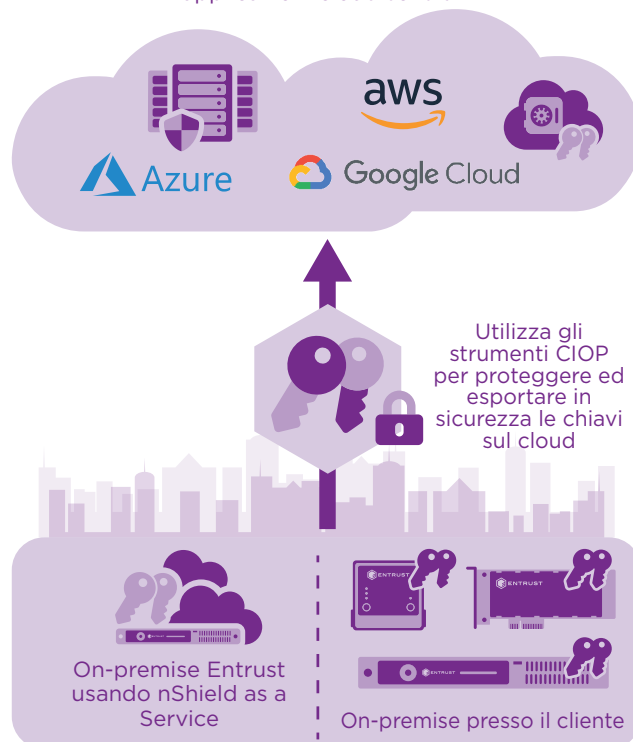
Figura 1. Le chiavi di crittografia vengono generate in un HSM nShield, per poi essere protette ed esportate in sicurezza sul cloud
