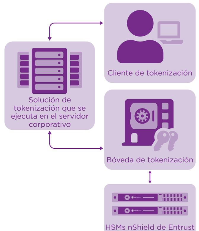
Los HSMs nShield de Entrust alojan la clave raíz maestra para la función de tokenización y también pueden realizar funciones críticas dentro de su límite seguro mediante la ejecución de código seguro de CodeSafe.
